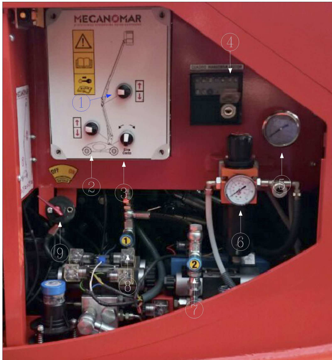
Foto 7: Mandos en la base de la plataforma
