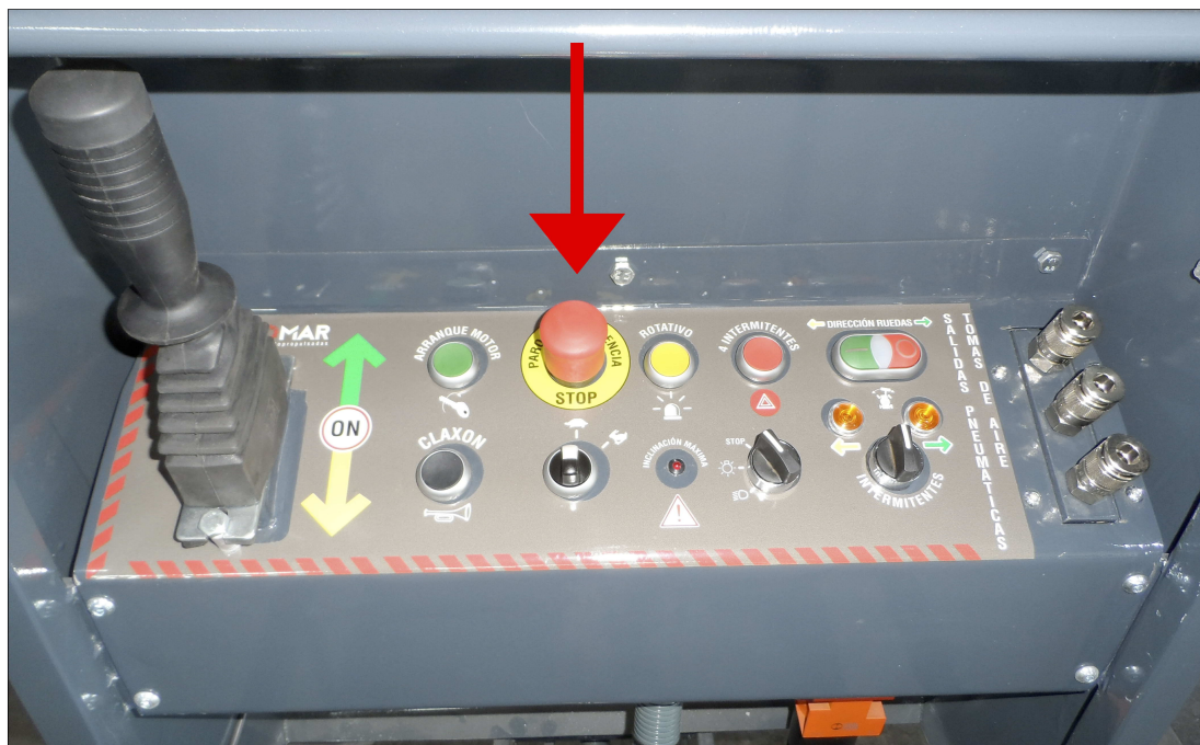
Foto 17: Parada de emergencia en la cesta
